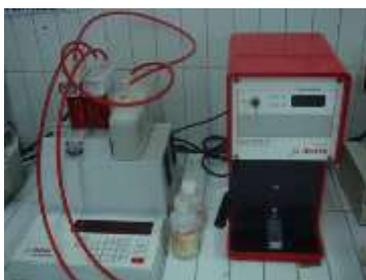
Figura 4. Equipo detector de carga polielectrolítica PCD-03 Mütek
