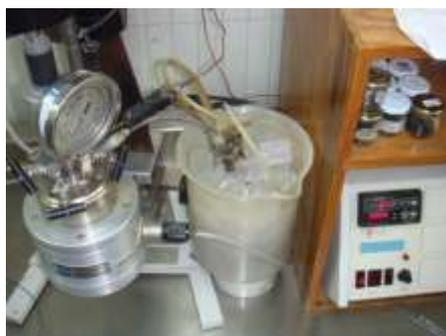
Figura 5. Tratamiento hidrotérmico y condensación del olote en una etapa en un reactor Parr.
