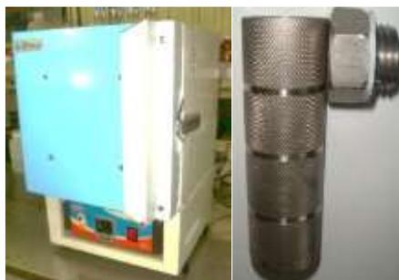
Figura 3. Tratamiento hidrotérmico del olote en mufla y reactores tipo bala.
