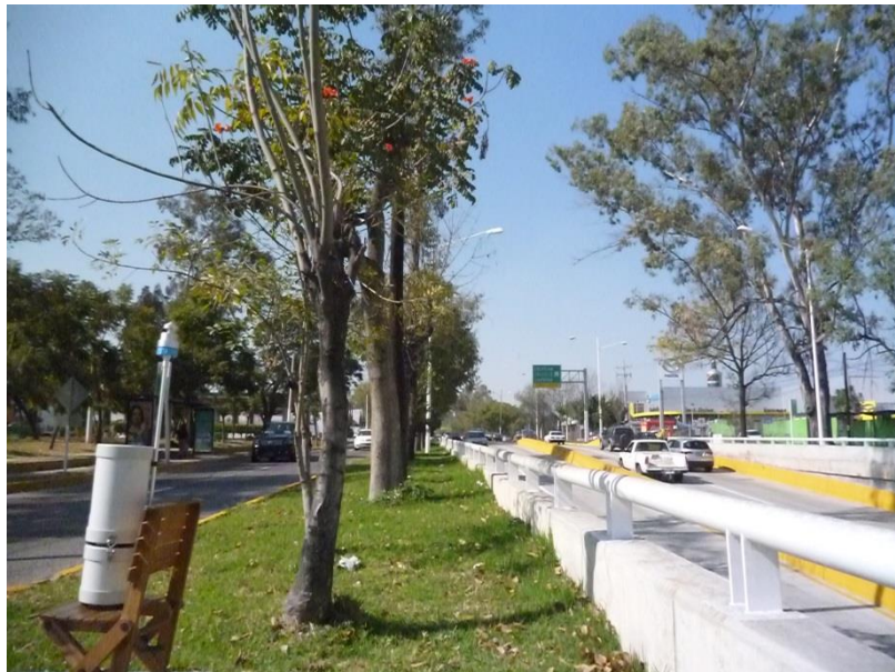
EQUIPO DE MONITOREO DE PARTÍCULAS PM 10 EN OBRA 1
