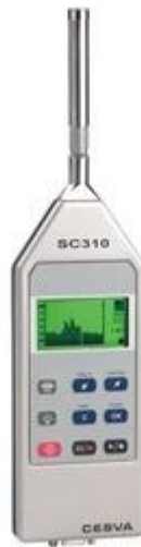
Figura 6.5. Sonómetro CESVA modelo SC310, con el que se realizó el monitoreo de los niveles de presión sonora.
