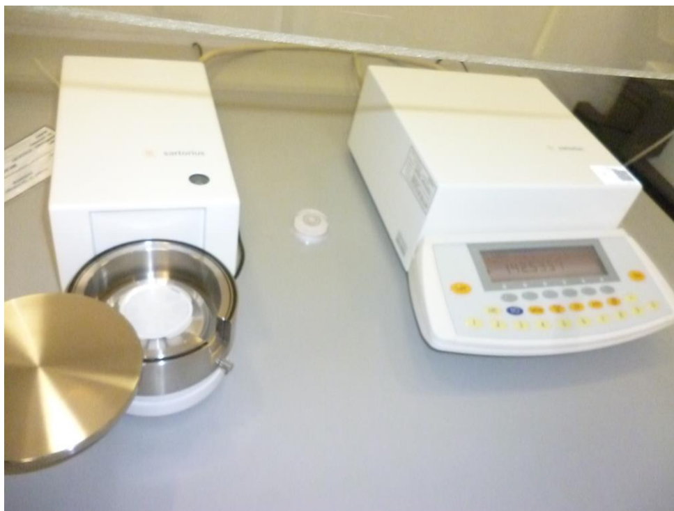
Figura 6.4. Balanza Microanalítica SE2F (Sartorius) para pesaje de filtros bajo condiciones controladas de temperatura y humedad relativa.
