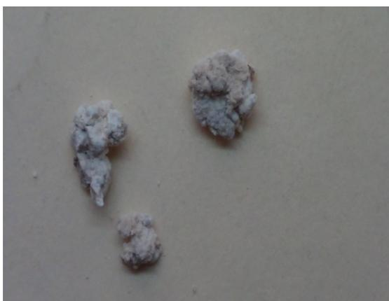
Figura 10. Agregados de partículas de perlita formados en el primer reuso (P1) derivadas de P0.
