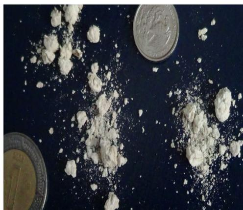
Figura 11. Fragmentación de los agregados de perlita en el segundo reuso (P2).
